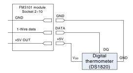
Figure 5. Digital thermometer DS1820 connection scheme
