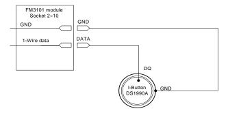
Figure 6. Digital key "I-Button" DS1990A connection scheme
