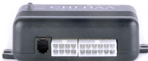
Рис. 1. Системный блок изделия СИГНАЛ (вид спереди)
