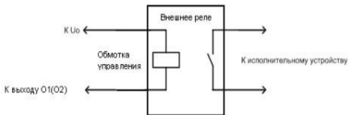
Рис. 26. Схема подключения внешнего реле к выходам устройства O1, O2
