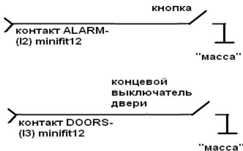
Рис. 15 Подключение сигналов ALARM- и DOORS- для варианта использования входов I2 и I3 с тревожными датчиками
