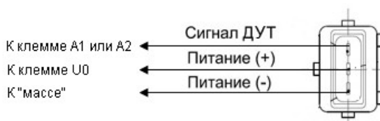
Рис. 21. Схема подключения ДУТ
