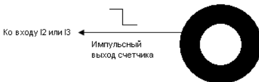
Рис. 17. Подключение импульсного датчика расхода топлива
