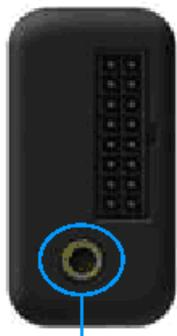
Разъем для подключения антенны ГНСС
